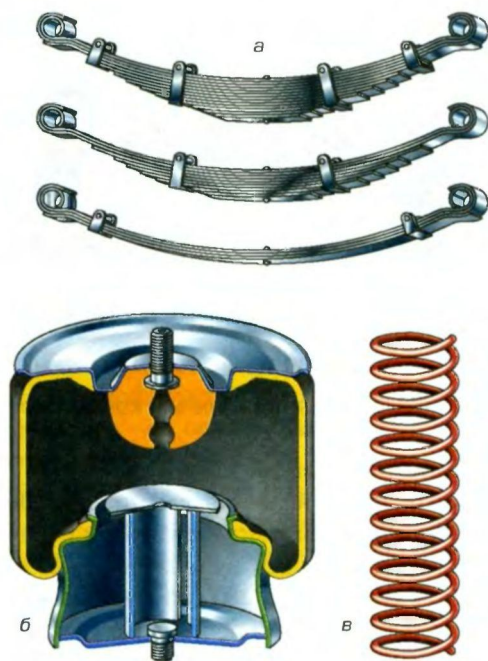
Рис. 42. Виды упругих элементов подвески: а — рессоры; б — пневмобаллон; в — пружина.
